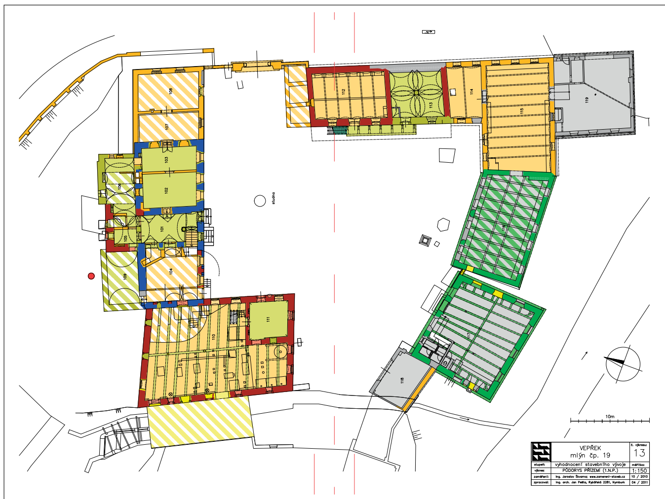
Obr. 2: Vepřek, areál mlýna, vyhodnocení stavebního vývoje, 1. nadzemní podlaží (repro z: J. Pešta, SHP, archiv NPÚ ÚOPSC).
