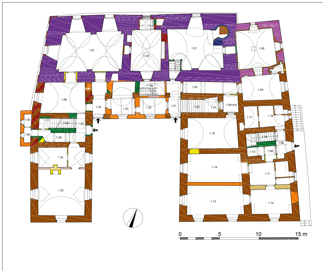
Obr. 10: Hořovice, Starý zámek, půdorys přízemí s barevným vyhodnocením stavebního vývoje (zaměření a kresba J. Veselý 2024, s využitím plánů z roku 1931).
