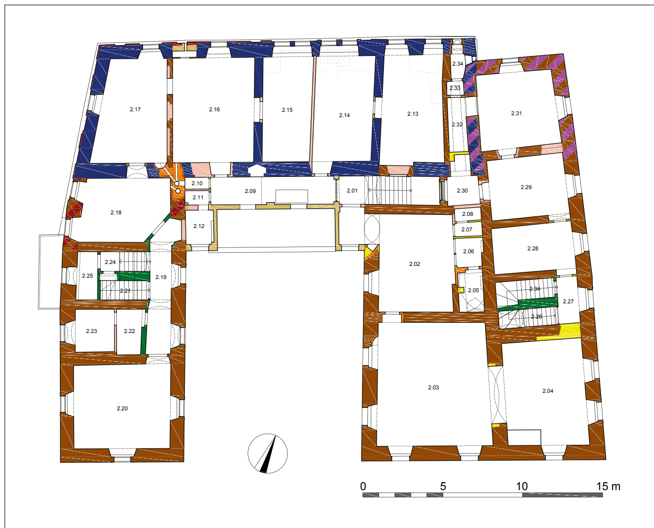
Obr. 28: Hořovice, Starý zámek, půdorys 1. patra s barevným vyhodnocením stavebního vývoje (zaměření a kresba J. Veselý, 2024, s využitím plánů z roku 1931).
