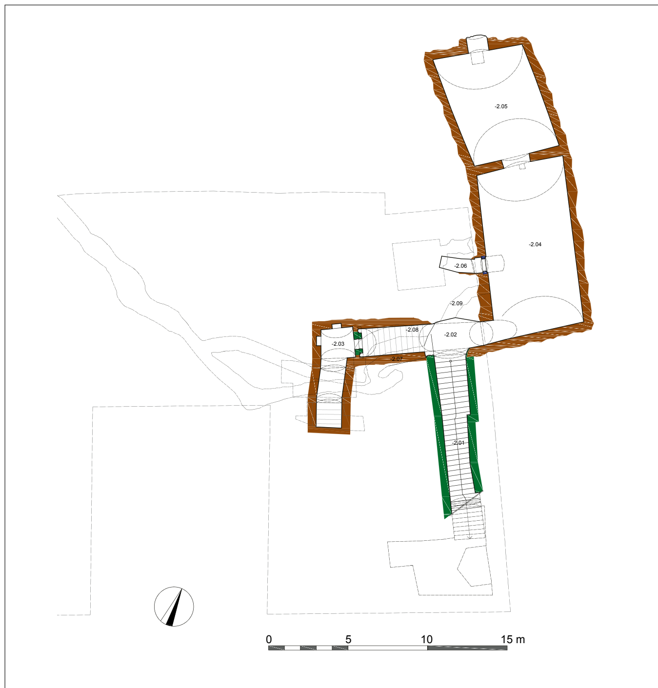
Obr. 34: Hořovice, Starý zámek, půdorys tzv. pivovarských sklepů ve druhém suterénu, s barevným vyhodnocením stavebního vývoje (zaměření a kresba J. Veselý, 2024).
