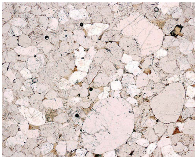
Obr. 5: Mikrofoto petrografického výbrusu vzorku horniny z Plzeňské brány. Jemnozrnný pískovec až křemenc tvořený 90 až 95 % suboválnými až oválnými zrn sekundárně rekrystalovaného křemene, s obsahem matrix 5 až 10 %. Foto v rovnoběžných polaroidech. Delší strana foto odpovídá 3 mm (V. Žáček, 2004).
